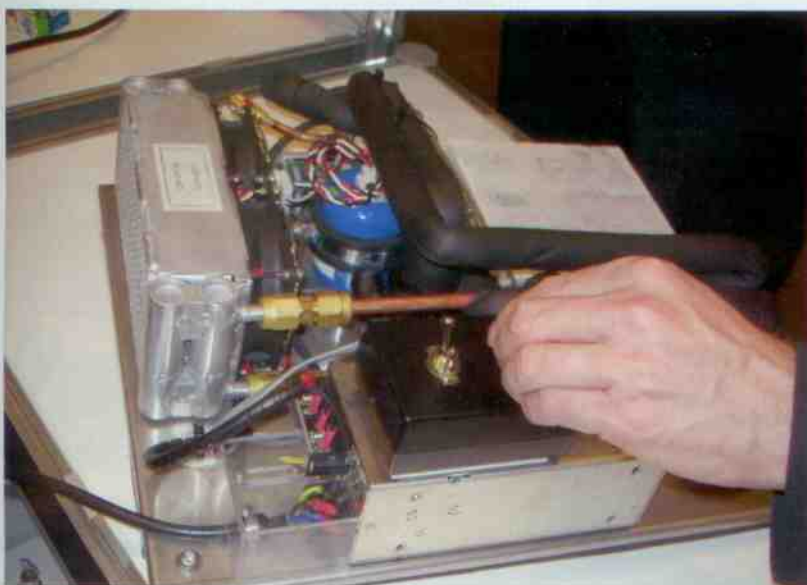
Diodenlaser-Kühlung mit Drehzahlregelbarkeit und ohne Wasserkreislauf: das Laserdirektkühlungs-System von Termotek.
